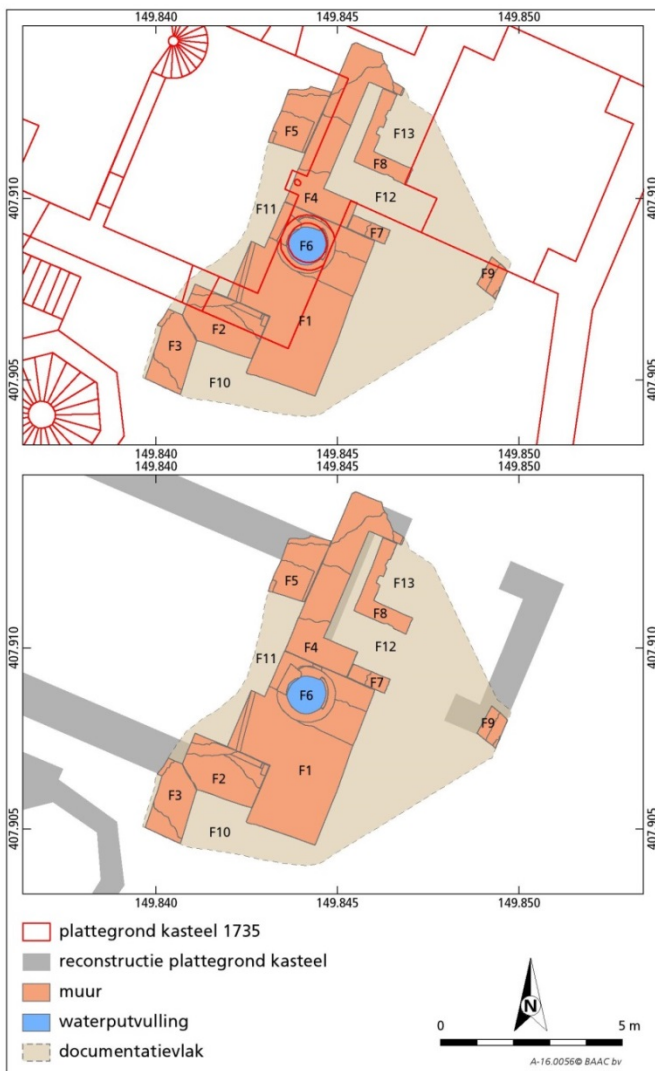
Afb. 3.11 Reconstructie ligging kasteel. Boven de inmeting van de daadwerkelijk aangetroffen muurresten ten opzichte van inmeting uit 1735. De waterput dient als vast punt. Onder de aangetroffen muurresten in combinatie met een door BAAC gemanipuleerde/geschaalde inmeting uit 1735. Zie bijlage 4 voor een combinatie van beide tekeningen.
